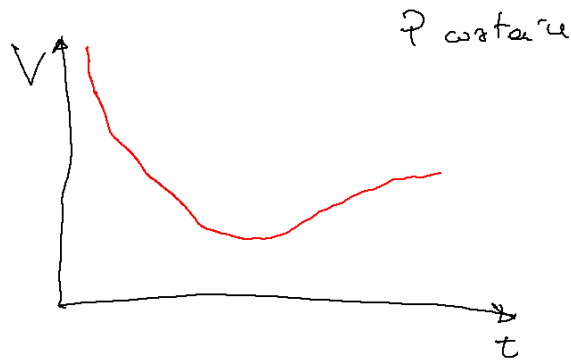
Figura 5.22: Questo risultato è molto strano. Perché si ottengono due punti con stesso volume, stessa pressione, stessa temperatura e quindi stessa T_{fin} . Tuttavia i due stati non possono essere uguali perché la pendenza del volume è differente in questi due stati. Questo implica che l'evoluzione termodinamica è differente e due sistemi non possono essere uguali. Quindi questi parametri non bastano per descrivere la termodinamica del sistema.
